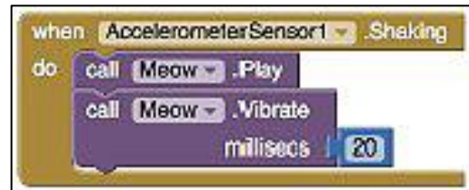
รูปที่ 11 การกำหนดการทำงานโดยการเขย่าโทรศัพท์มือถือ (MIT App Inventor, n.d.)
